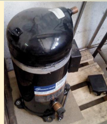
Hermetic scroll compressor (Copeland: ZP137-KCE-TFD)
