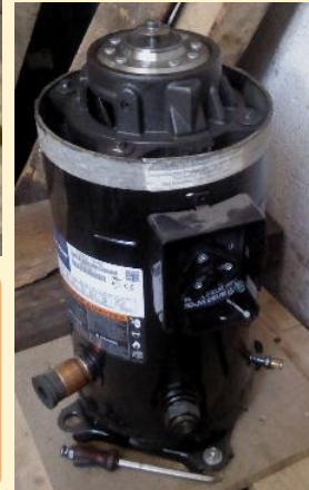
Hermetic scroll compressor (Copeland: ZP137-KCE-TFD)
